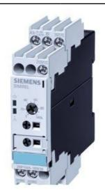
MULTIFUNCTION TIME RELAY 15 TIME RANGES MIT SCREW CONNECTION 2 CHANGEOVER, 8 FUNCTIONS POSITIVELY DRIVEN + GOLD-PLATED RELAY CONTACTS, AC/DC 24V...240V
