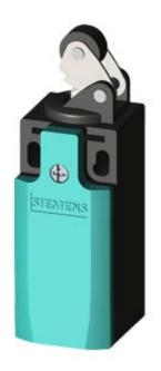
SIRIUS POSITION SWITCH METAL HOUSING ACC. TO EN50047, 31MM DEVICE CONNECTION 1X(M20X1.5); 1NO/1NC SNAP-ACTION CONTACTS ROLLER LEVER W. PLASTIC ROLLER 13MM
