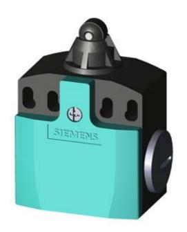
SIRIUS POSITION SWITCH; PLASTIC HOUSING ACC. TO EN50047, 50MM DEVICE CONNECTION 2X(M20X1.5); 1NO/1NC SNAP-ACTION CONTACTS ROLLER PLUNGER W. PLASTIC ROLLER 10MM
