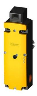
SAFETY POSITION SWITCHES WITH SOLENOID INTERLOCKING LOCK. FORCE 1300N,5 APPR. DIR. PLASTIC ENCLOSURE,3X(M20X1.5) SPRING-LOCKED, EMERGENCY RELEASE ON REAR A. AUXILIARY RELEASE ON FRONT, MAGNET VOLTAGE 230V AC, MONITOR. OF ACTUATOR 2NC/1NO, MONITOR. OF MAGNET 2NC/1NO LEDS YELLOW/GREEN
