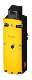
SAFETY POSITION SWITCHES WITH SOLENOID INTERLOCKING LOCK. FORCE 1300N,5 APPR. DIR. PLASTIC ENCLOSURE,3X(M20X1.5) SPRING-LOCKED, ESCAPE RELEASE FROM REAR AND AUX. RELEASE ON FRONT MAGNET VOLTAGE 24V DC, MONITOR. OF ACTUATOR 2NC/1NO, MONITOR. OF MAGNET 2NC/1NO LEDS YELLOW/GREEN
