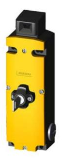
SAFETY POSITION SWITCHES WITH SOLENOID INTERLOCKING LOCK. FORCE 2600N,5 APPR. DIR. METAL HOUSING,3X(M20X1.5) SPRING-LOCKED, AUXILIARY RELEASE W. LOCK MAGNET VOLTAGE 24V DC,
