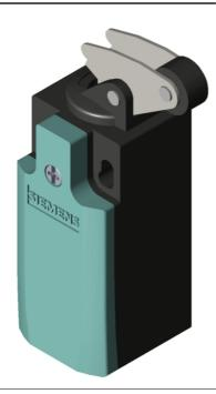
SIRIUS POSITION SWITCH; PLASTIC HOUSING ACC. TO EN50047, 31MM DEVICE CONNECTION 1X(M20X1.5); 1NO/1NC SNAP-ACTION CONTACTS INTEGRATED (NOT REPLACEABLE) ANGULAR ROLLER LEVER W. PLASTIC ROLLER 13MM
