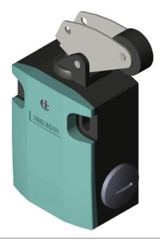
SIRIUS POSITION SWITCH METAL ENCLOSURE 56MM WIDE DEVICE CONNECTION 3X (M20X1.5) 1NO/1NC SNAP-ACTION CONTACTS ANGULAR METAL ROLLER LEVER AND PLASTIC ROLLER 22MM
