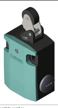
SIRIUS POSITION SWITCH METAL ENCLOSURE 56MM WIDE DEVICE CONNECTION 3X (M20X1.5) 1NO/1NC SNAP-ACTION CONTACTS METAL ROLLER LEVER AND PLASTIC ROLLER 22MM
