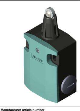
SIRIUS POSITION SWITCH METAL ENCLOSURE 56MM WIDE DEVICE CONNECTION 3X (M20X1.5) 1NO/1NC SNAP-ACTION CONTACTS ROLLER PLUNGER WITH STAINLESS STEEL ROLLER 13MM
