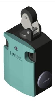
SIRIUS POSITION SWITCH METAL ENCLOSURE 56MM WIDE DEVICE CONNECTION 3X (M20X1.5) 1NO/1NC SLOW-ACTION CONTACTS METAL ROLLER LEVER AND PLASTIC ROLLER 22MM
