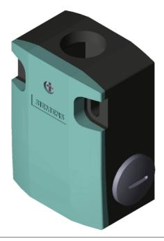
SIRIUS POSITION SWITCH METAL ENCLOSURE 56MM WIDE DEVICE CONNECTION 3X (M20X1.5) 1NO/ 1NC SLOW-ACTION CONTACTS PLAIN PLUNGER, STAINLESS STEEL
