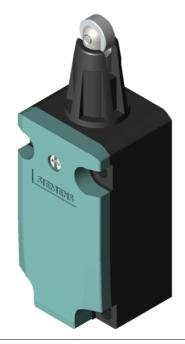
SIRIUS POSITION SWITCH METAL HOUSING 40MM TO EN50041 DEVICE CONNECTION 1X (M20X1,5) 1NO/ 1NC SNAP-ACTION CONTACTS ROLLER PLUNGER W. STAINL. STEEL ROLLER 13MM
