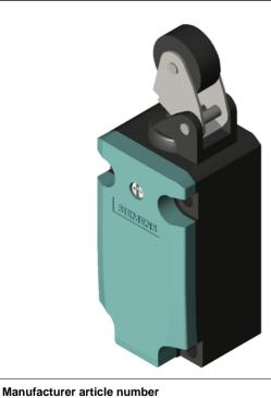
SIRIUS POSITION SWITCH, METAL ENCLOSURE 40MM ACC. TO EN50041 DEVICE CONNECTION 1X (M20X1.5) 1NO/1NC SLOW-ACTION CONTACTS METAL ROLLER LEVER AND PLASTICROLLER 22MM
